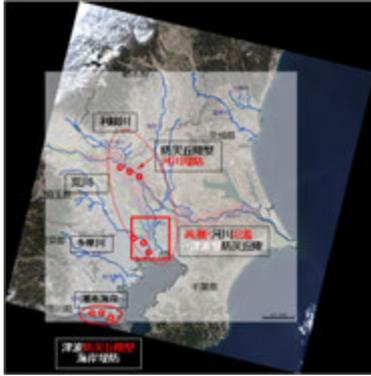
図 利根川栗橋付近の破堤に対する函体内蔵型河川堤防(防災丘陵)の配置。および利根川破堤を考慮した衛星データであるLandsat8のNatural画像。浸水図は「川の防災情報」浸水想定区域:利根川。
