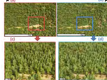
Fig.4 3Dモデル 上図左(a)直下視のみ、下図右(b)直下視+斜め視 下図左(c)直下視のみ、下図右(d)直下視+斜め視
