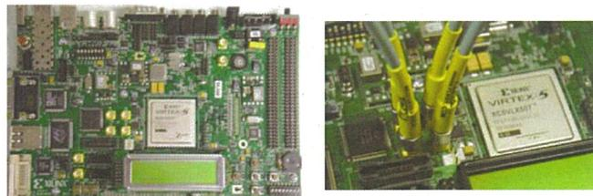
内部RAMとDSPセルが多いFPGAを搭載
