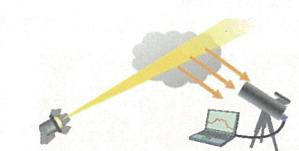
サーチライト型光源を利用して、散乱光のスペクトルを取得する。DOAS法と同様にスペクトルからNO<sub>x</sub>濃度などを測定できるほか、散乱強度からエアロゾルの情報を得ることができる。
