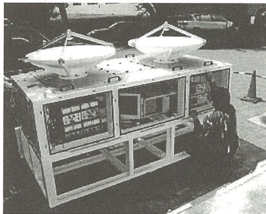
図1 我々が開発した 95GHz ミリ波 FM-CW レーダの外観
