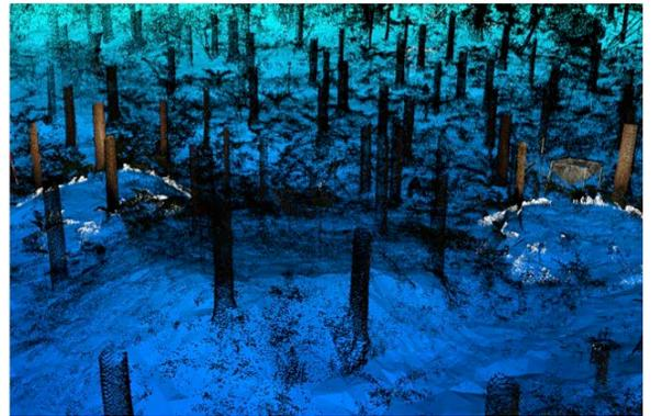
膨大な点群データから地盤（青色）を分離し、地盤から2mまでの樹木データを表示した例（オリジナル点群データはJAXA/GCOM-Cプロジェクトで取得されたものです）。
