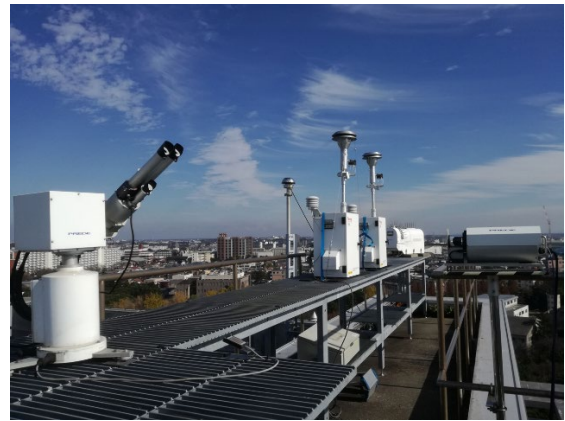
図1 (左) 千葉集中観測キャンペーン(Chiba Campaign 2020)の目的。(右) キャンペーン初日の観測サイトの様子。手前左がスカイラジオメーター、真ん中の2台の装置がFRM サンプラ、一番右がMAX-DOAS 装置。
