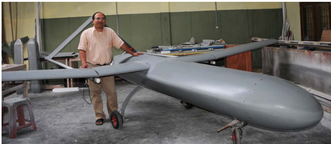
図1. 完成した当センターの円偏波合成開口レーダ搭載無人航空機 (CP-SAR UAV)
