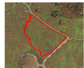
図2 燃焼境界線(赤線)の現地測量
