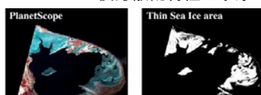
図1 PlanetScopeデータによって検出された薄氷域
