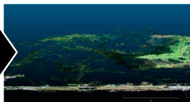
図1 UAV-LiDARを用いた里山空間林床地形の可視化プロセス
