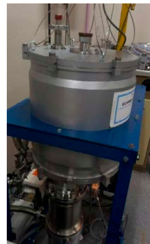
図2 耐環境試験に使用する高真空チャンバー
