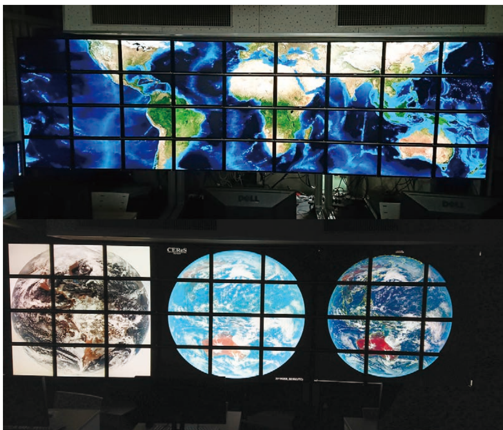
図9.4-2. ChOWDERを用いた画像の全画面表示（上）と、12面×3台それぞれに6Kサイズの高解像動画を表示する様子（下）
