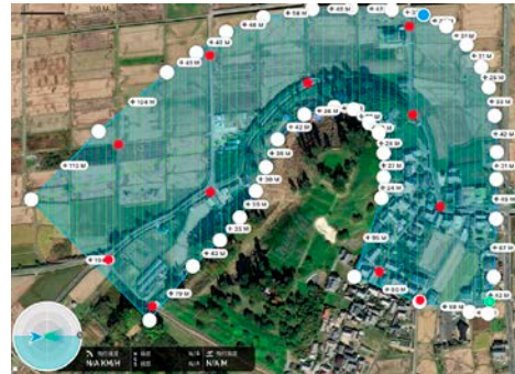
図2 Phantom 4 Proによる撮影範囲 赤丸はGNSS計測地点
