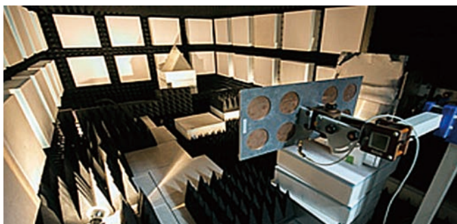
図9.2. 電波無響室内の様子
