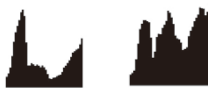
図2. ある1画素の転移学習用のグラフ画像例 ・左: 濡れ雪, 右: 濡れ路面
