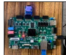
図2 本年度使用したローエンド FPGA、冷却ファンは必要ない
