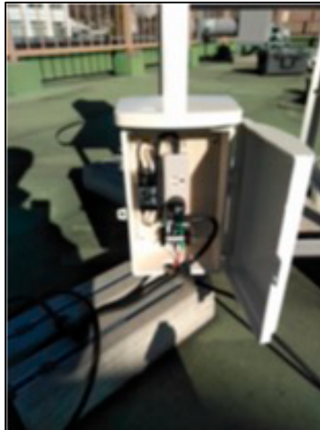
図1 開発中の機材の全景 コンクリート製による転倒防止 機能追加
