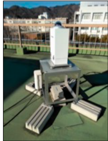
図2 野外観測対応の電源防水対策強化
