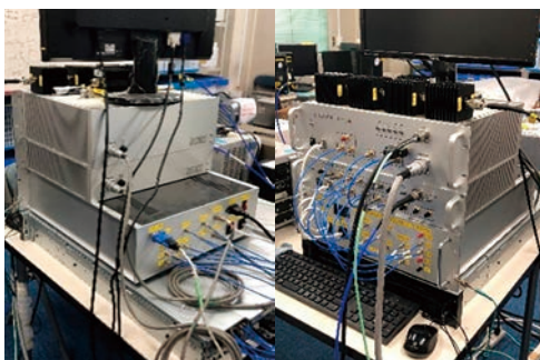
図1.1.1.1-1. Chirp generator used so far
