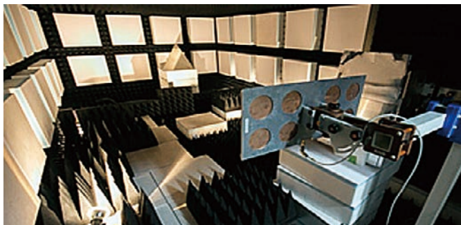
図9.2. 電波無響室内の様子
