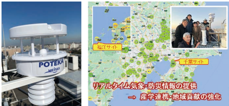
図 1.3.2.3. （左）千葉大学大気環境観測サイトに設置したPOTEKA小型気象計の外観。（右）各種気象データはWebにてリアルタイム配信されている。なお、入江研究室が管理している福江島大気環境観測施設においても本年度、防災科学技術研究所においてPOTEKAが新設された。
