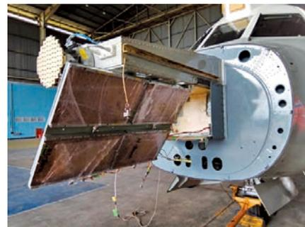
図1.1.1.-8. CP-SARの送受信用のマイクロストリップアンテナとCN235航空機に搭載した状態
