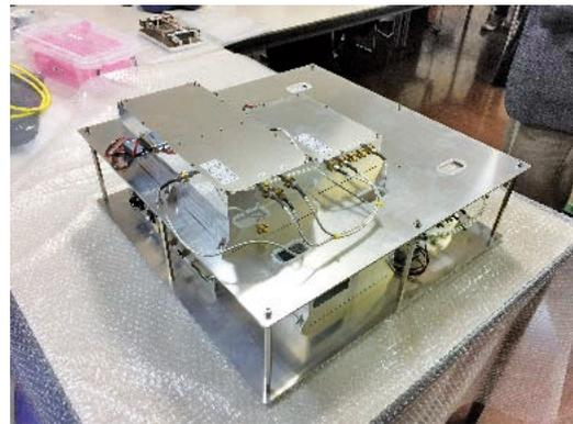
図1.1.1.-4. 小型衛星搭載CP-SARのRFシステム
