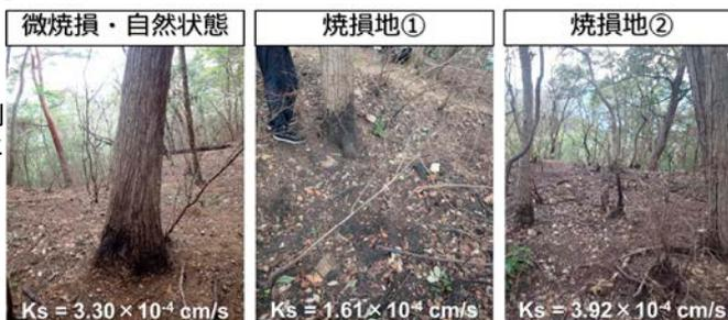
図2 サンプルング地点と透水係数の試験結果
