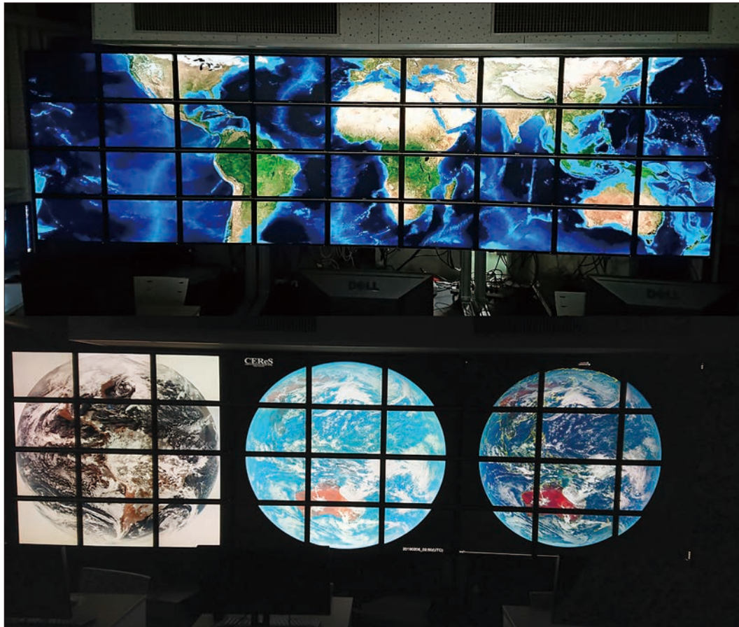
図9.5.-2 ChOWDERを用いた画像の全画面表示（上）と、12面×3台それぞれに6Kサイズの高解像動画を表示する様子（下）
