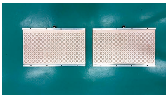
図1.1.1-8. CP-SARの送受信用のマイクロストリップアンテナとCN235航空機に搭載した状態
