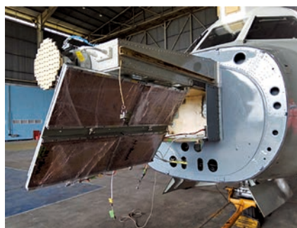
図1.1.1-8. CP-SARの送受信用のマイクロストリップアンテナとCN235航空機に搭載した状態
