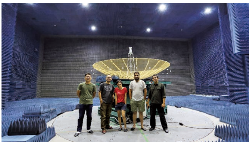
図1.1.1.-18. 金メッキメッシュパラボラアンテナの電波特性の測定
