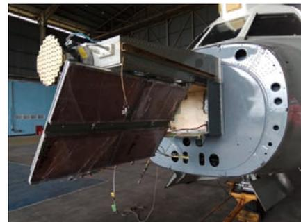
図1.1.1.-8 CP-SARの送受信用のマイクロストリップアンテナとCN235航空機に搭載した様子
