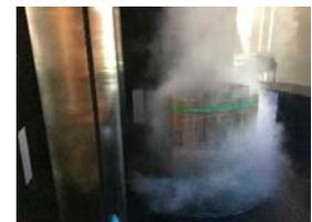
図1 段ボールの設置で渦の形を制御している様子
