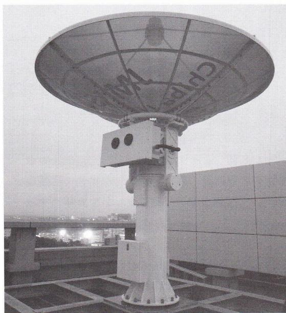
屋上に設置した CP-SAR の観測データ受信アンテナ
