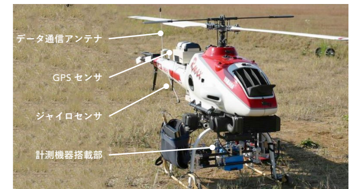
自律飛行ヘリコプタ観測システムの外観（腹部にレーザープロファイラ、デジカメ、スペクトロメータなど搭載） Radio Control Helicopter Observation system
