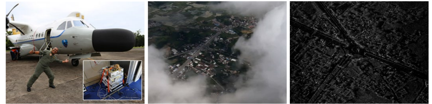
航空機搭載CP-SAR・光学センサと円偏波合成開口レーダの取得画像の比較：(左図) 光学センサの取得画像（雲あり）、(右図) 円偏波合成開口レーダの取得画像（雲なし） 2018年3月14日取得
