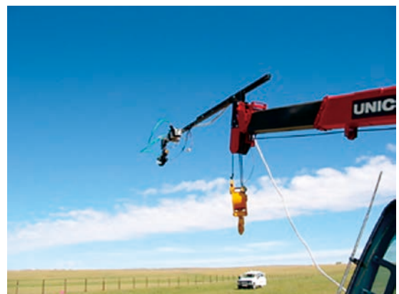
図3.1 マンダルゴビ空港における植生の二方向性反射率特性（BRDF）の計測 9
