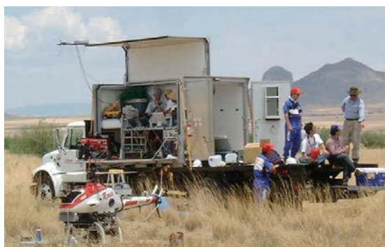
図5 分光放射計、レーザースキャナ等の機材を同時搭載可能なラジオコントロールヘリコプターと基地局
