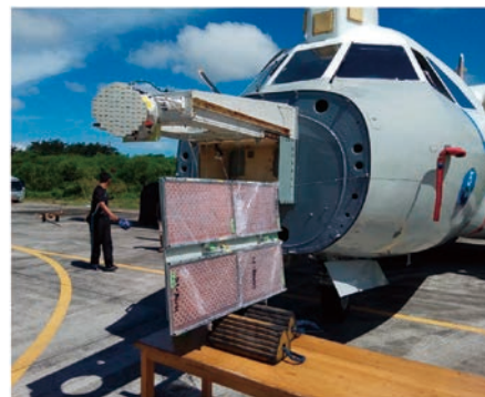
図4 CP-SARセンサのポイントターゲットテスト Fig. 4 Point target test of CP-SAR sensor.
