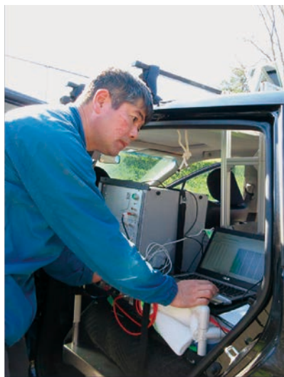
著者近影：車載ライダー装置の調整
