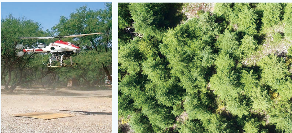
図3.2 産業用ラジオコントロールヘリコプターに観測機材を搭載し、大面積のスペクトル観測を可能とする機材を開発した。右図の樹木エリアはおよそ横30 m×縦20 mである。
