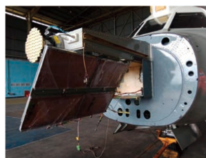
図5 CP-SARの送受信用のマイクロストリップアンテナとCN235航空機への搭載 Fig. 5 Microstrip array antenna for TX-RX of CP-SAR and installation on CN235 aircraft.
