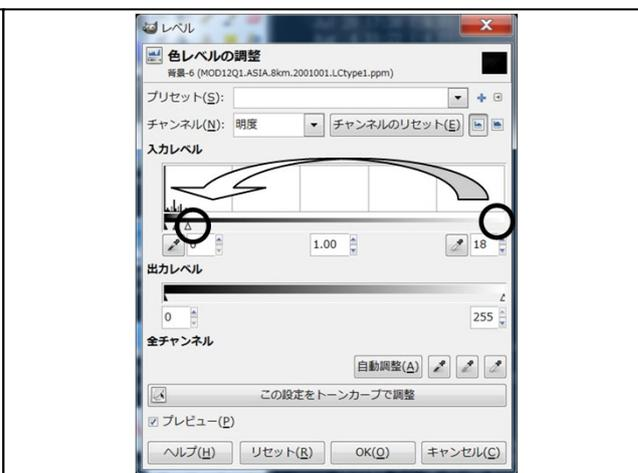
図 3. ストレッチ処理の画面。最大値を小さくすればよい(図の矢印)。
